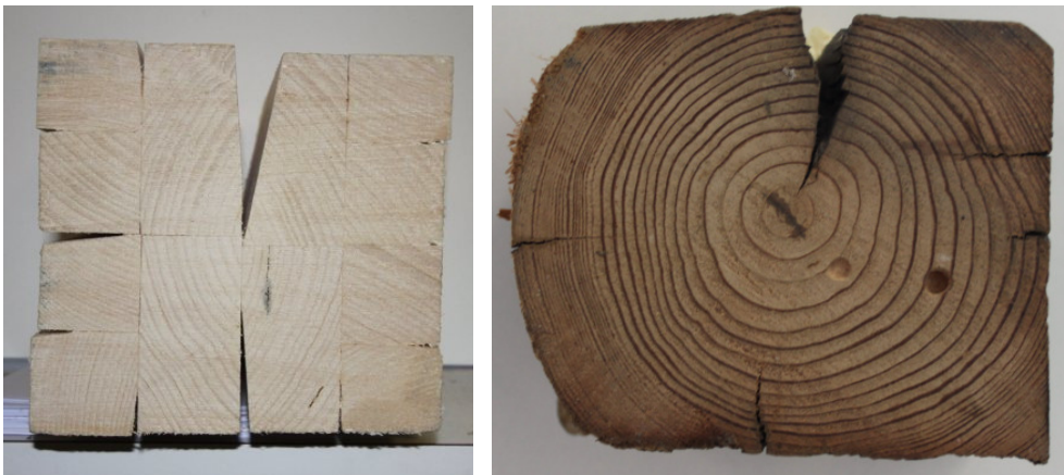
Abbildung 13: Schnittfläche eines großen Musterbalkens (ca. 16 mm x 15 mm) sowie eines Altbalkens (ca. 120 mm x 145 mm)
