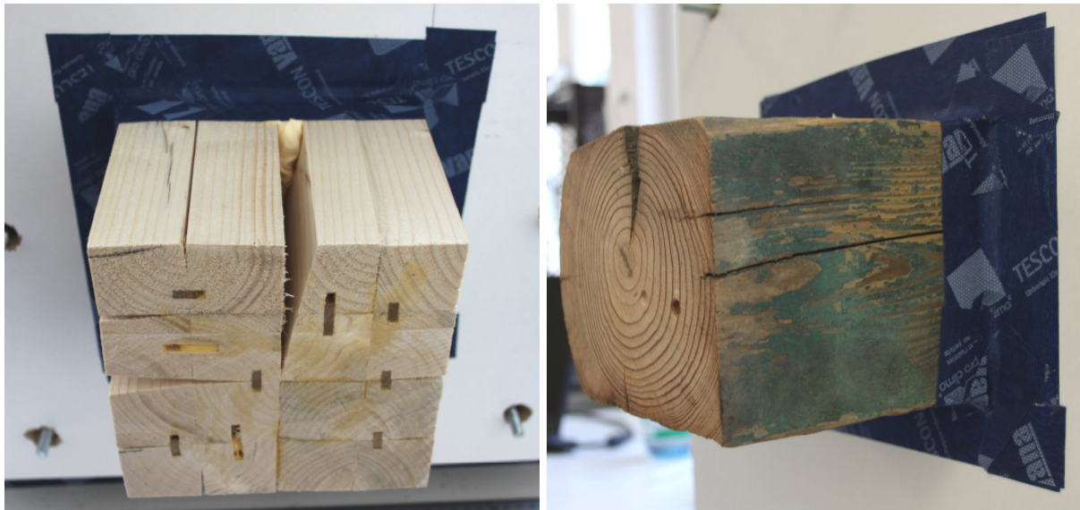
Abbildung 33: Abgedichteter Musterbalke „groß“ (links) und Alt- bzw. „Real“balke (rechts)
