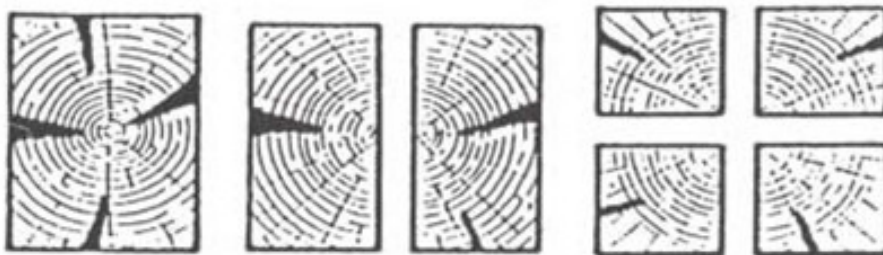
Abbildung 9: Verlauf von Trockenrissen bei unterschiedlichen Einschnittarten (links.: Vollbalken; Mitte: Halbbalken; rechts: Viertelbalken) (Quelle: [GDHeV])
