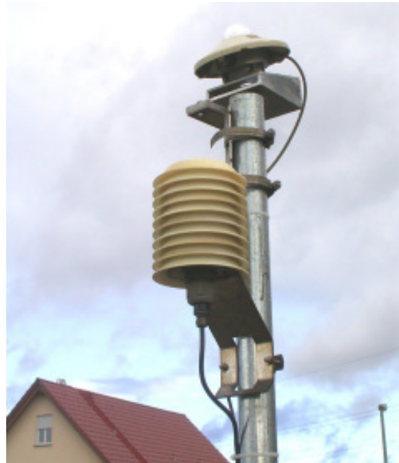
Abbildung 33: Wettermast im Garten mit dem Solarstrahlungsmessgerät in Dachneigung und einem kombinierten Lufttemperatur- und Feuchtesensor im belüfteten Strahlungsschutzgehäuse .
